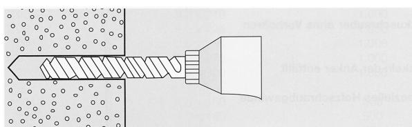
Mit Stahlbohrer 10 mm Ø Loch bohren.
