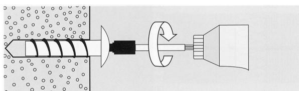
Dübel mit Eindrehadapter und Schraubwerkzeug eindrehen.
